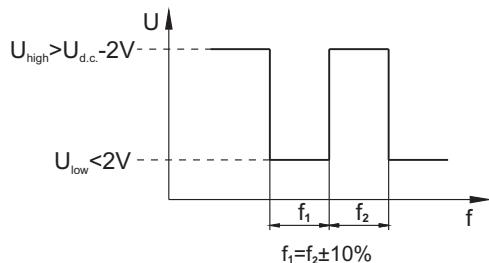
$$\text{Load max.: } I_{\text{high}} = I_{\text{low}} < 50 \text{ mA}$$
